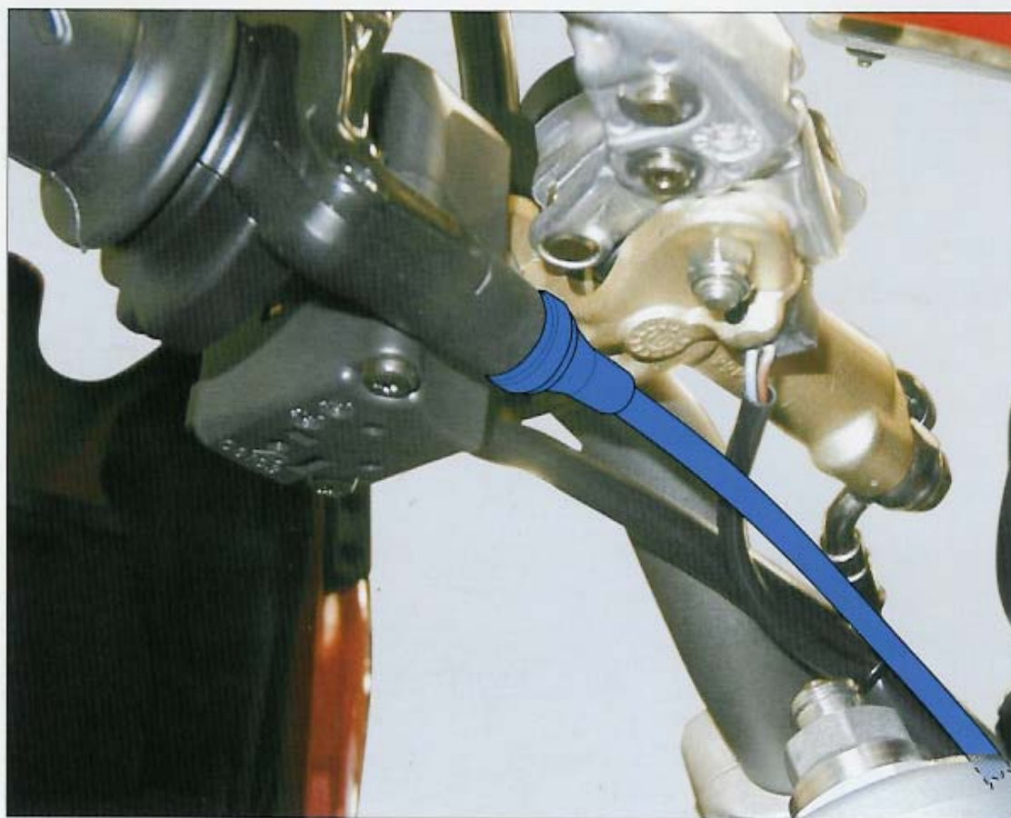
Posizionamento cavo comando acceleratore Throttle cable routing
